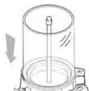
Attention: vérifier le montage correct du joint; un montage erroné du joint provoque des fuites de produit; risque de brûlures!
